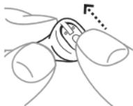
Чтобы включить слуховой аппарат, закройте крышку батарейного отсека и надавите на нее вверх. При включении слухового аппарата вы услышите звуковой сигнал, если ваш специалист не отключил эту функцию.
