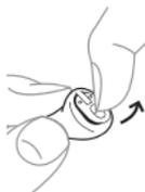
Чтобы выключить слуховой аппарат, надавите на крышку батарейного отсека вниз.
